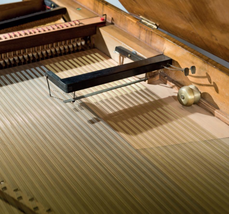
Blick auf Prellzungenmechanik und Vorrichtungen des Janitscharenzugs / A view of the Viennese action type and devices of the Janissary stop
